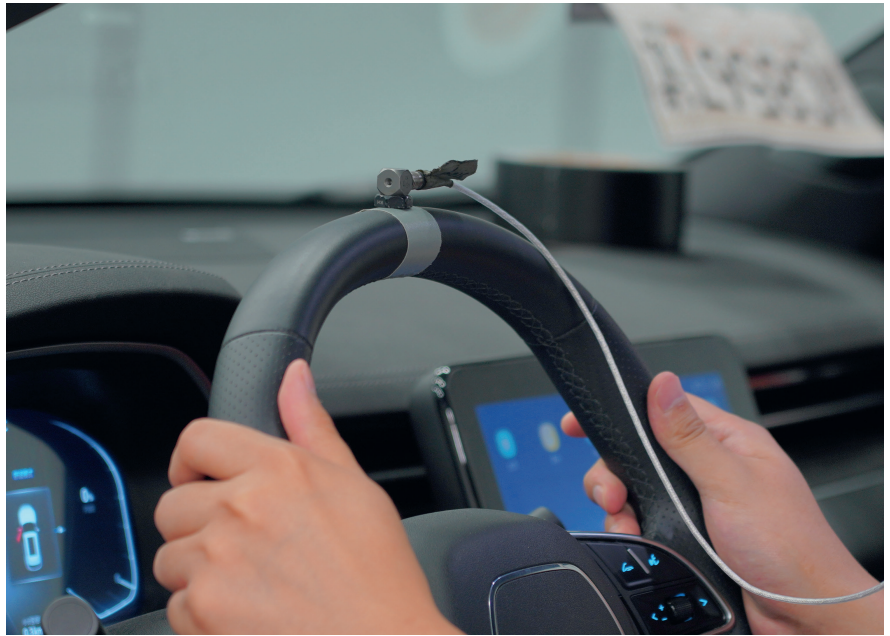
Bild 3: Ein Beschleunigungssensor 8763B von Kistler ist auf einem Lenkrad montiert: NVH-Test am China Automotive Engineering Research Institute in Chongqing. © Kistler
